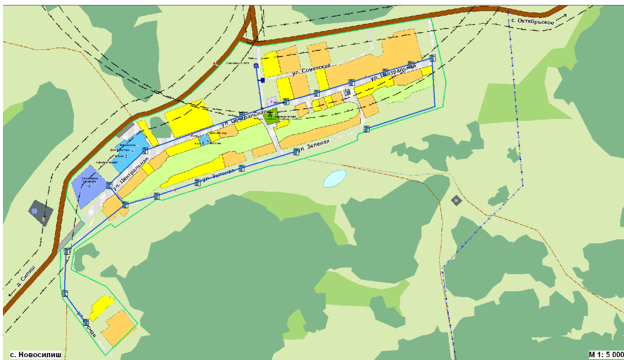
Рисунок 8 - Существующая схема водопроводной сети с. Новосилиш
